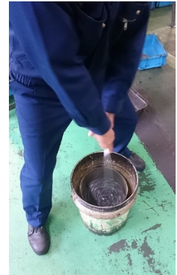
③洗浄(手作業) ・加工油の除去 ・次工程でのパーツフィーダ 整列供給力アップ
