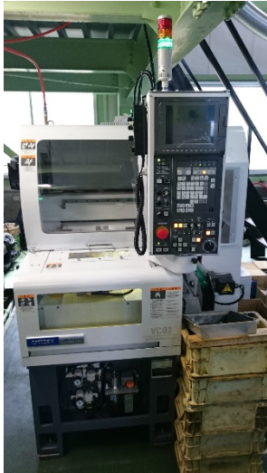
低周波振動NC切削機:VC03 シチズンマシナリー製
