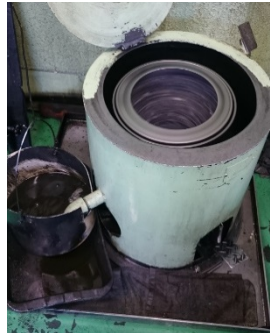
②振切り 前工程加工油 の除去
