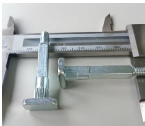
材質:SWCH12A 数量:30,000ヶ/月 使用:自動車のドアミラー固定部品 特徴:小判据と込四角絞りの複合成形
