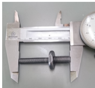
材質:SCM435 数量:15,000ヶ/月 使用:小型汎用エンジンの マウントボルト 特徴:焼入れ後転造加工
