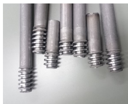
材質：SWCH10R 平ダイス転造にてウォームギア成形をトライ してみました。変形量が大きく素材が 破断したり、バリや剥がれが出てしまう ため、量産時には相当な工夫が必要 になると思いました。
