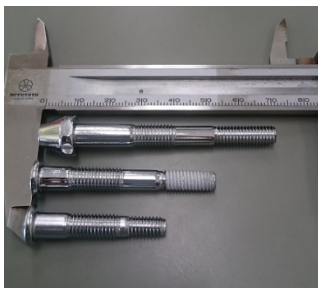
材質:SCM435 数量:50,000ヶ/月 使用:自転車のブレーキ部品 特徴:焼入れ後転造加工
