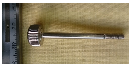
材質:SWCH12A 数量:30,000ヶ/月 使用:取付ネジ(手回し) 特徴:据込比:3.9倍 絞り率:75%
