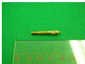
材質：C2700W 数量：1,000,000ヶ/月 使用：自動車メーター端子部品 特徴：切削レス(転造加工)
