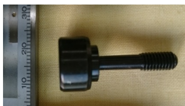
材質:SWCH12A 数量:10,000ヶ/月 使用:プリンター内部締結 特徴:据込比:4.1倍 絞り率:75%
